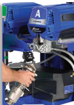
٣. قم بإزالة الخرطوم وأزلق المضخة نحو الخارج
